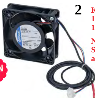
119x119x38mm 24VDC 9W kuulalaakeroitu kaapeli 200 mm 4414HT
